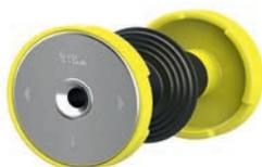
Die isolierte Erdungsdurchführung von Hauff-Technik ist besonders für den Stationsbau geeignet und dient u. a. auch als optionale Messtrennstelle für die Erdungsanlage. Über die isolierten Erdungsdurchführungen kann die Funktion des Ringerders außerhalb der Station separat überprüft werden. Über Kreuzklemmen bzw. Anschlussbolzen können Rund- oder Flachstähle bzw. Kabelschuhe angeschlossen werden. Erfolgreiche Kurzschlussprüfung nach DIN EN 50522 (VDE 0101-2):2011-11.
