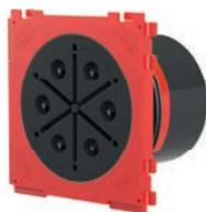
Die Einfach-Dichtpackungen werden bevorzugt in nicht begehbaren Stationen zur Kabelabdichtung eingesetzt. Die Mindestwandstärke beträgt 70 mm. Einfach-Dichtpackungen sind neben dem druckdichten Verschlussdeckel zusätzlich mit einem Sicherheitsdeckel bestückt, der erst unmittelbar vor der Kabelverlegung entfernt wird. Diese doppelte Sicherheit schützt zusätzlich vor Wassereintritt beim versehentlichen Öffnen der Verschlussdeckel.
