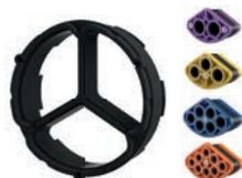
Mit dem bei Segmento verwendeten Abdichtwerkstoff Technogel können Kabel besonders schonend abgedichtet werden. Es stehen vier Segmente im Anwendungsbereich von 5 – 31 mm zur Auswahl, die in beliebiger Kombination im Systemdeckel HSI 150-S3 montiert werden. Die Nachbelegung ist sehr montagefreundlich. Alle Segmente werden inklusive Blindstopfen ausgeliefert.
