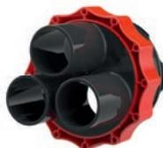
Die Systemdeckel mit Bajonettssystem werden vor der Kabelverlegung in den Dichtpackungen montiert. Für die Kabelabdichtung stehen je nach Anforderung die Systemdeckel HSI 150-D1/80, HSI 150-D3/58 und HSI 150-D7/33 zur Verfügung. Im Lieferumfang sind Warm- oder wahlweise Kaltschrumpfmuffen enthalten. Unbelegte Stutzen werden mit Verschlussstopfen VS verschlossen.
