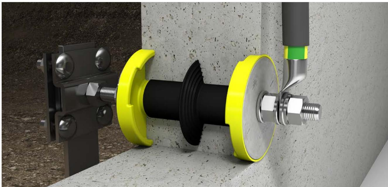
Erdungsdurchführung HEA-IS-M12: auf der einen Seite Anschluss eines Flachstahls über Kreuzklemme Z-KG-M12 und auf der anderen Seite Anschluss eines Erdungsleiters über den Anschlussbolzen Z-B-M12.
