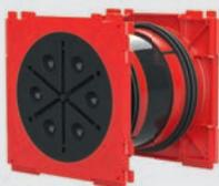
Doppel-Dichtpackungen werden bevorzugt in begehbaren Stationen eingesetzt. Die Mindestwandstärke beträgt 100 mm. Sie sind ab Werk beidseitig mit druckdichten Verschlussdeckeln mit Bajonettsystem bestückt. Doppel-Dichtpackungen bieten z. B. die Möglichkeit, Kabelschutzrohre anzuschließen und zusätzlich zum Kabel abzudichten.
