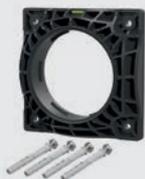
Die Dichtheit zur Wand wird durch eine 6 mm starke überlappende Flächendichtung aus EPDM erreicht. Die Befestigungselemente sind aus hochwertigem Edelstahl inklusive Dichtscheibe. Eine integrierte Wasserwaage vereinfacht die horizontale Ausrichtung. Alle Systemdeckel und Systemabdichtungen aus dem HSI 150-Programm können eingebaut werden.
